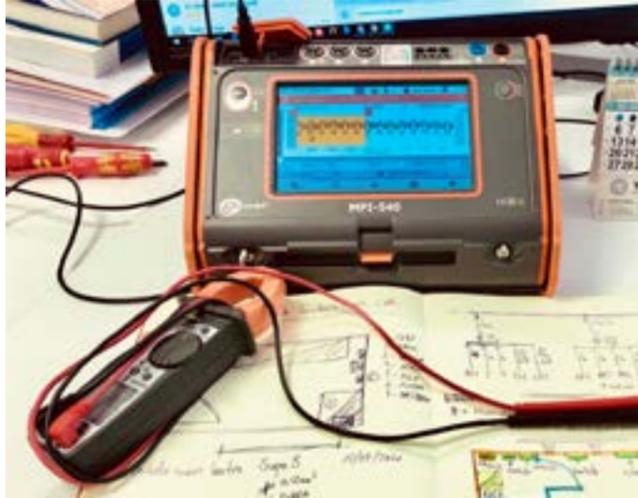
Contamos con un **equipo auditor** que analizará la calidad de la red eléctrica y nos permite identificar posibles problemas en la calidad del suministro, bien micro cortes, armónicos... y en general aquellos factores que puedan afectar al servicio de una instalación provocando paros intempestivos de procesos, fallos o roturas de equipos, etc. que provocan grandes pérdidas económicas en los procesos.
